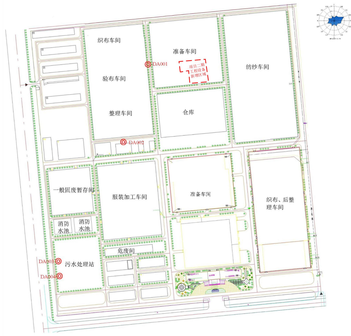
图 3-2 生产区平面布置图
